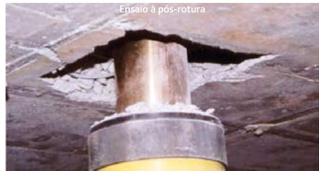
**Figura 10** Face inferior do modelo AR11 após ensaios ao punção e à pós-rotura
