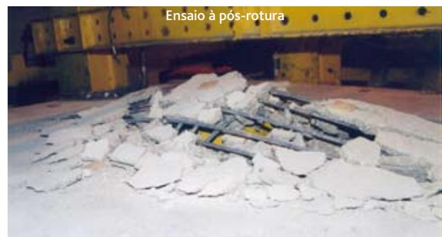
**Figura 11** Face superior do modelo AR15 após ensaios ao punção e à pós-rotura
