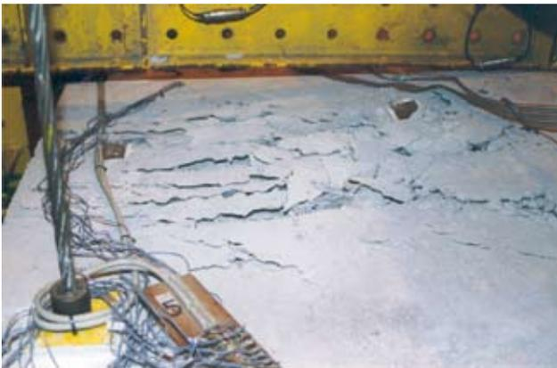
**Figura 8** Aspecto da face superior dos modelos com destacamento do recobrimento da armadura longitudinal superior
