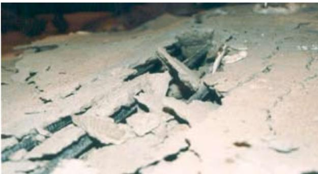
**Figura 9** Rotura por esforço transversal junto a um dos bordos do modelo AR8
