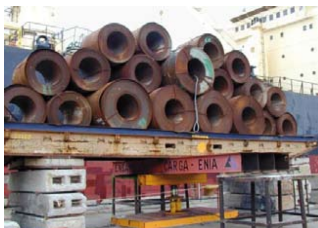
Figura 6 Prueba de carga “in situ”
