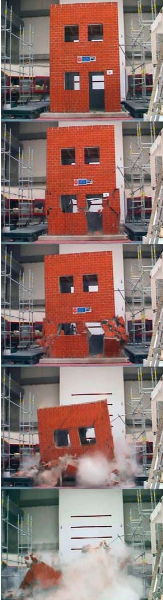
Colapso de um edifício em alvenaria não reforçado (Projecto ECOLEADER LIS)
