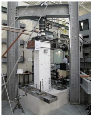
**Figura 1** Pilares de betão armado em estudo a) secção transversal e detalhes de armaduras para cada série; b) dimensões gerais e c) *setup* experimental
