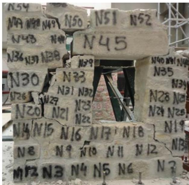
Figura 5 Modelo de pedra – evolução do dano e mecanismos formados (azul – fendas iniciais; verde – 0,66 g; amarelo – 1,02 g; vermelho (colapso) – 1,05 g)
