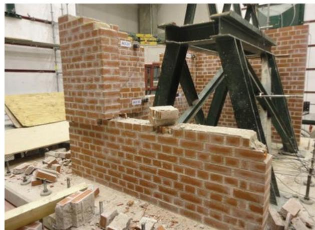
Figura 4 Modelo de tijolo – evolução do dano e mecanismos formados (azul – 0,56 g; verde – 0,84 g; vermelho (colapso) – 1,27 g).
