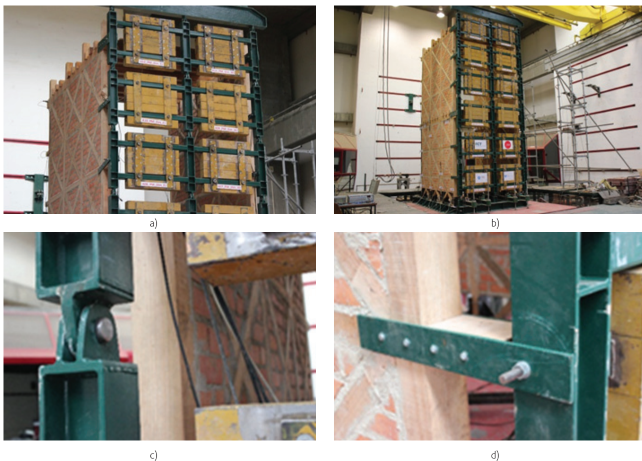
Figura 1 Modelos: a) parede metálica; b) modelo; c) ligação com rótulas; d) ligação da fachada a parede pombalina
