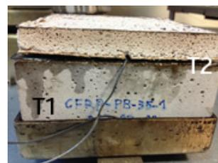
Figura 6 Provetes protegidos com placa de gesso
