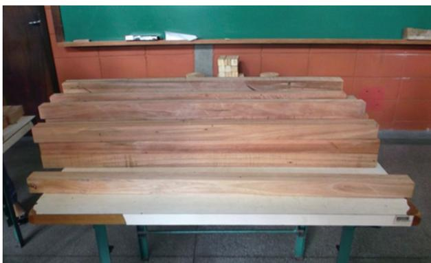
**Figura 1** Corpos de prova para ensaio de flexão estática, 5 x 5 cm de seção transversal e 115 cm de comprimento
