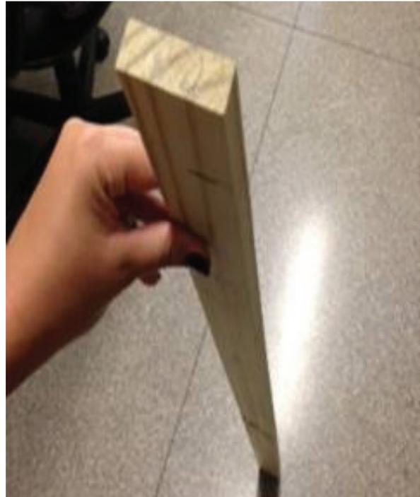
**Figura 2** Corpo de prova de *Pinus elliottii* com 1,67 cm de altura, 5 cm de largura e 115 cm de comprimento
