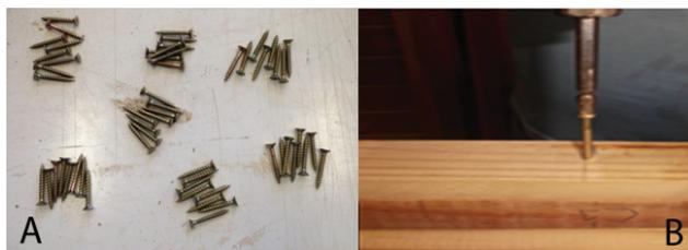
Figura 4 Parafusos autoatarraxantes de 4 mm de diâmetro e 40 mm de comprimento (A); Detalhe da fixação do parafuso na madeira (B)
