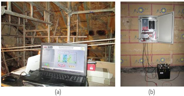
**Figura 16** (a) Visualización de la aplicación que gestiona los datos de los sensores fijos durante el desapeo, y (b) PC Industrial
