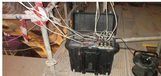
**Figura 11** Sistema portátil de adquisición de datos empleado en el sistema de control temporal
