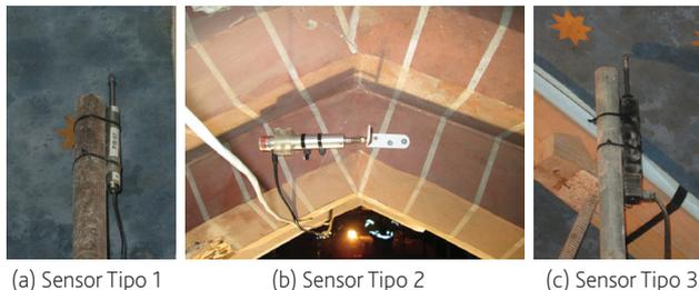
**Figura 8** Tipologías de sensores de desplazamiento empleados durante el desapeo de las bóvedas 2, 3 y 4
