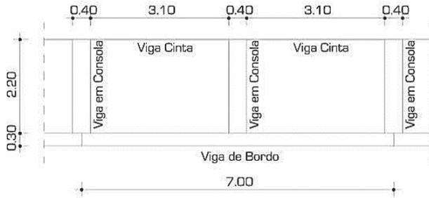
Figura 22 Esquema estrutural em análise
