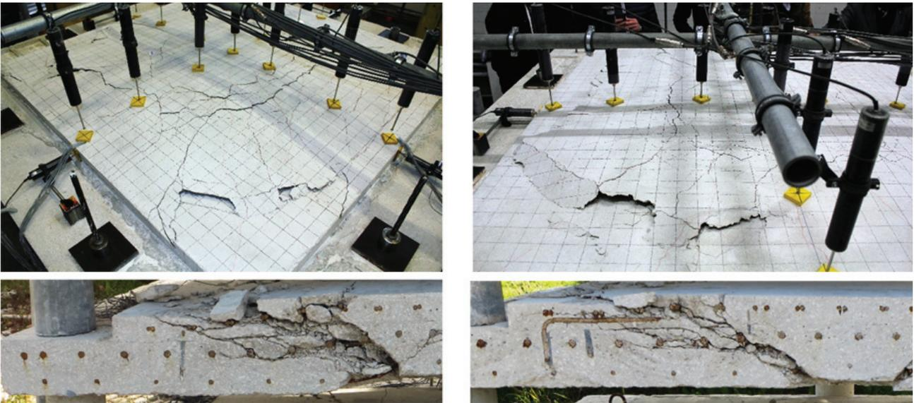
Figura 5 Rotura e pormenor da interface dos modelos SQ-STC e SQ-STANC
