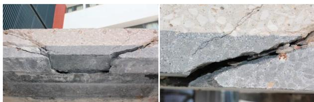
Figura 8 Vista pormenorizada da superfície de rotura do modelo SHSC8
