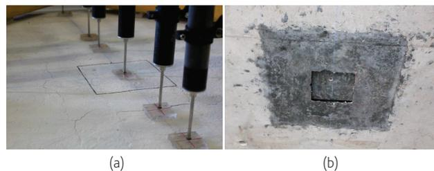
**Figura 7** (a) Vista superior do modelo SNSC6 antes da rotura. (b) Vista inferior do modelo SHSC7 após a rotura
