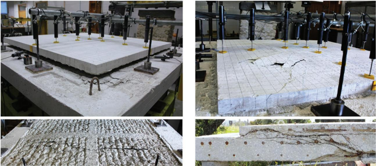
Figura 4 Rotura e pormenor da interface dos modelos SQ-REF (esquerda) e SQ-ANC (direita)
