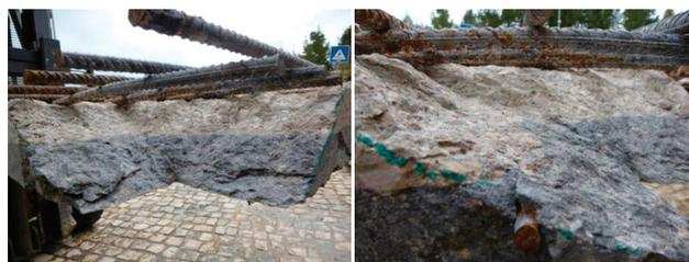
Figura 9 Detalhes da superfície de rotura do modelo SHSC5
