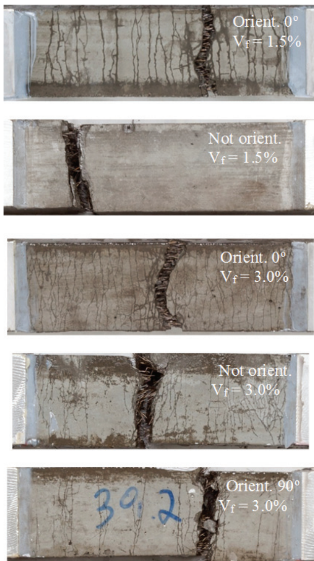
Figura 6 Padrões de fendilhação representativos dos provetes ensaiados
