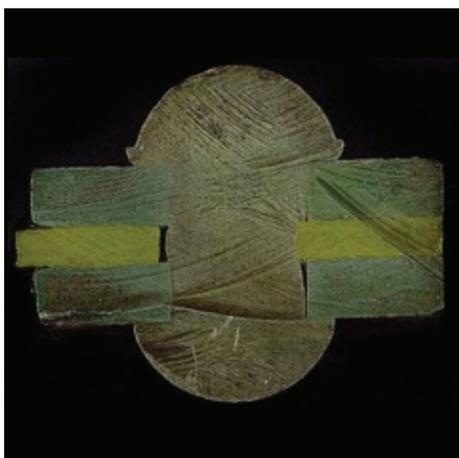
Figura 13 Vista de pormenor em corte de ligações rebitadas defeituosas
