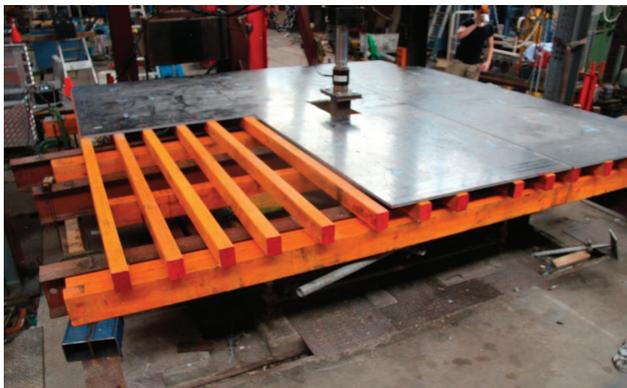
**Figura 13** Soalho rígido usado no experimento de Reynolds, Rasmussen e Zhang [15]
