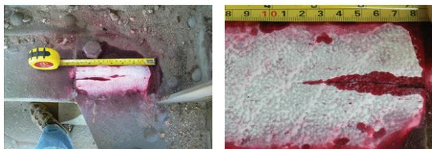
Figura 10 Ensaio de líquidos penetrantes numa placa de *gousset* para avaliação da extensão da fissura
