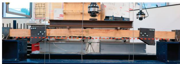
Figura 14 Viga VV1 com sistema de reforço instalado
