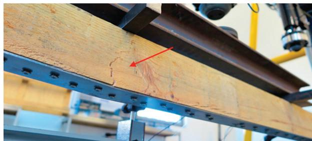
**Figura 12** Rotura do modelo VCH2
