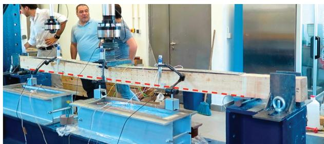
**Figura 10** Imposição de força para contraflecha nos modelos VCH1 e VCH2
