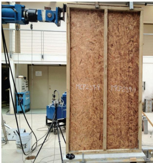
Figura 1 Configuración del muro ensayado
