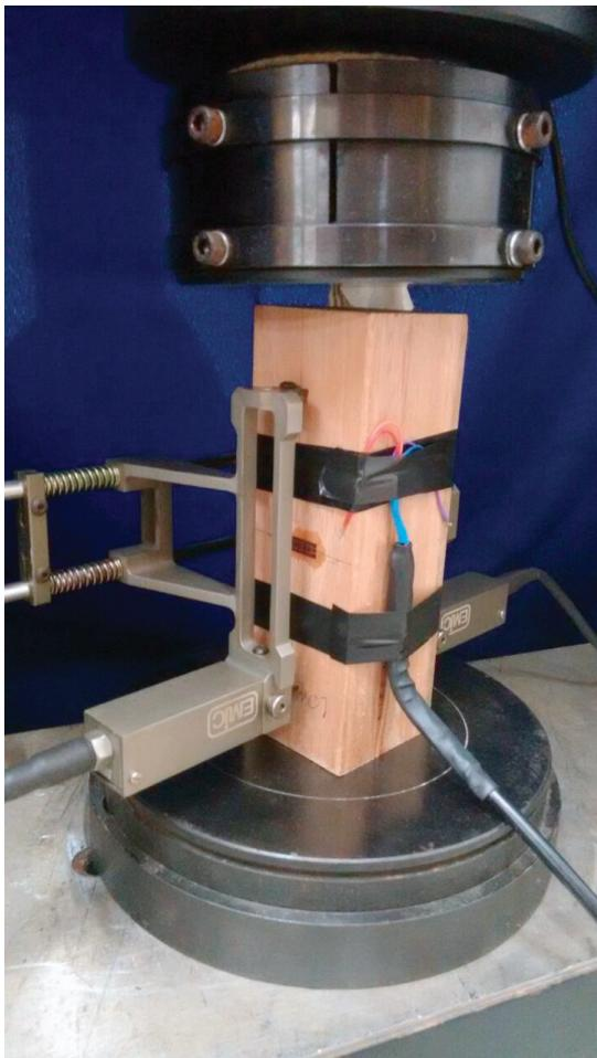
Figura 8 Corpo de prova instrumentado para ensaio
