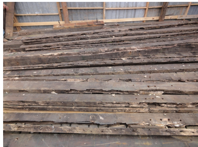
Figura 7 Biodeteriorações com características visuais de fungos apodrecedores, na região superior da seção das vigas transversinas superiores (TS) do módulo m13, em regiões de fixação das tábuas do tabuleiro. Foto: Dussarrat Brito (Inspeção in loco em 09/08/2013)
