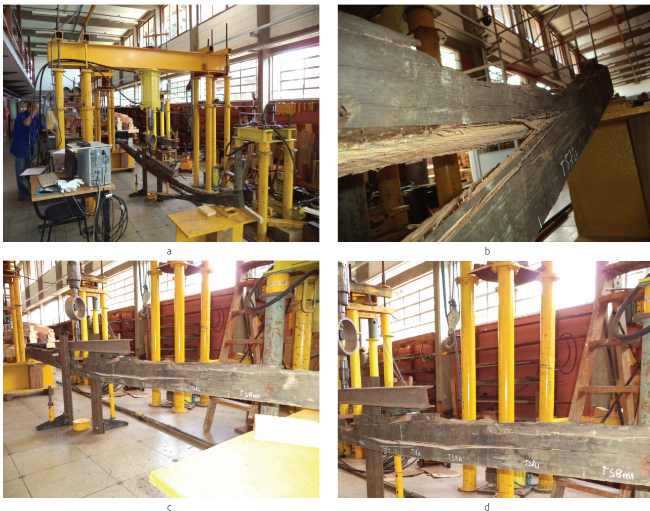
Figura 9 Ensaios estáticos de flexão de vigas transversinas parcialmente biodeterioradas na região superior de compressão. Destaca-se que foram notáveis à separação longitudinal, paralela às fibras da região de madeira sã da região da madeira biodeteriorada: a) modo de ruptura brusca (sem aviso) na TS7 (visão detalhada em b); c) modo de ruptura por cisalhamento na TS8 (visão detalhada em d). Fotos: Dussarrat Brito (2014)
