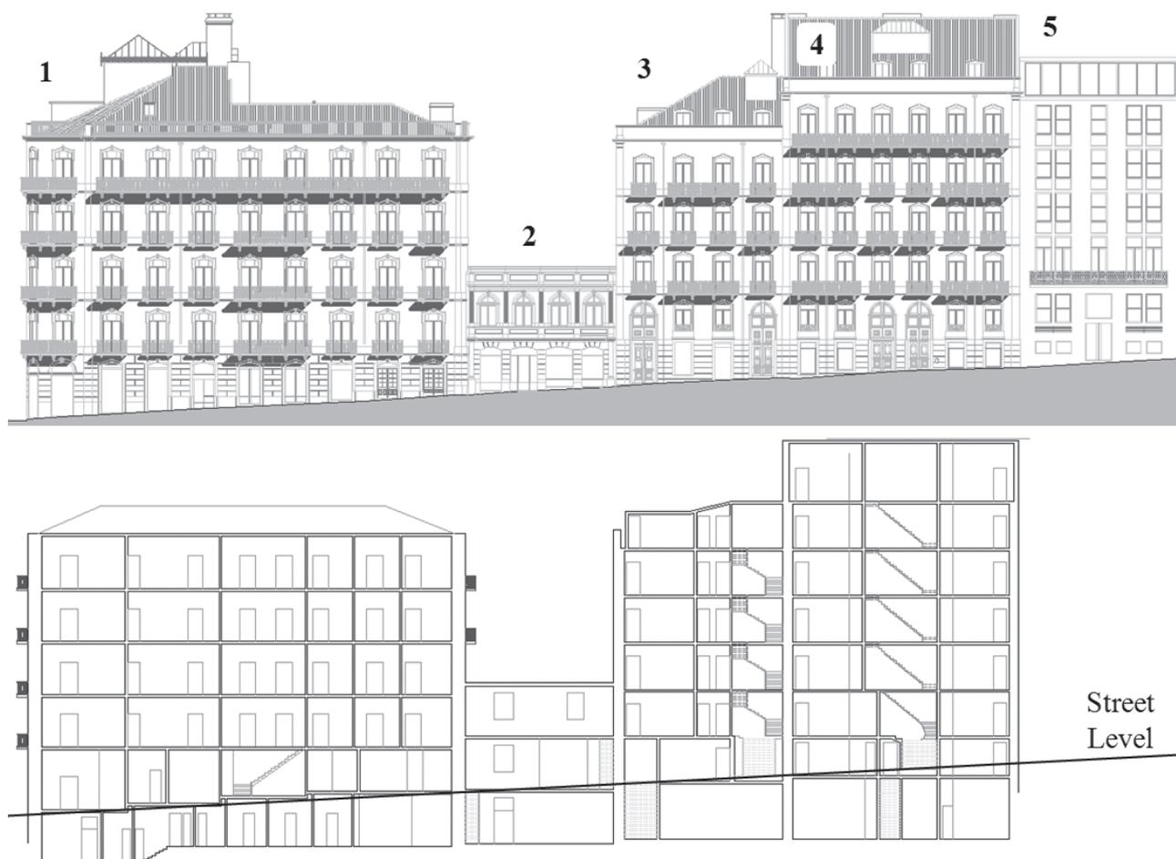
Figura 2 Alçado (Rua Rosa Araújo) e corte transversal dos edifícios existentes (1 a 5)
