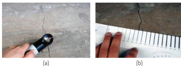
Figura 4 Métodos tradicionais: (a) amplificador de fendas graduado (CM); (b) régua de largura padrão (CWR)
