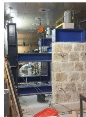
Figura 10 Configuração do ensaio para fora do plano: (a) Esquema em 3D; (b) Estrutura com perfil metálico HEB200; (c) Aplicação da carga vertical nas paredes transversais
