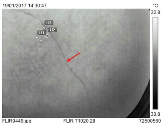
**Figura 6** Imagem infravermelha da cúpula da Av. Rio Branco
