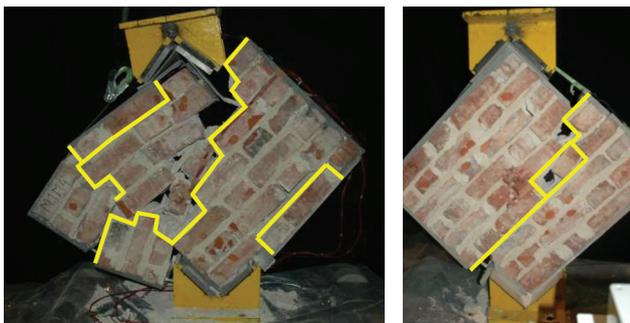
Figura 13 Roturas obtidas nos muretes novos ensaiados
