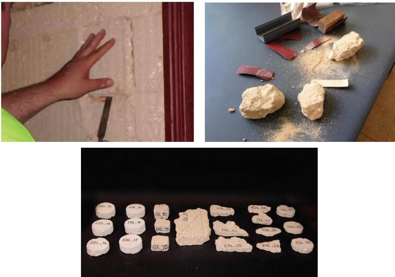
Figura 2 Preparação dos provetes de argamassa de revestimento e assentamento
