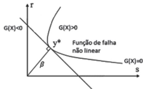
**Figura 5** Índice de confiabilidade com a linearização da função de falha
