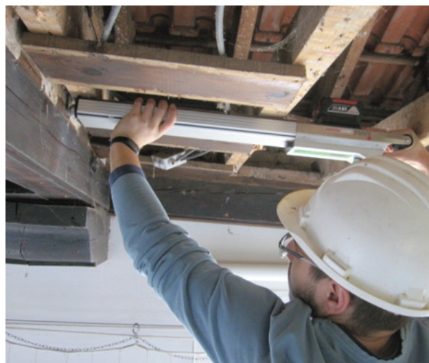
Figura 15 Perfuração com Resistógrafo
