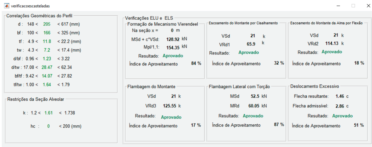
Figura 6 Interface do programa para apresentação dos resultados das verificações aos modos de colapso
