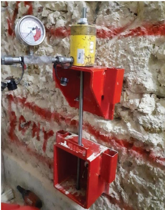
Figura 4 Modelo de ensaio ao corte - prático
