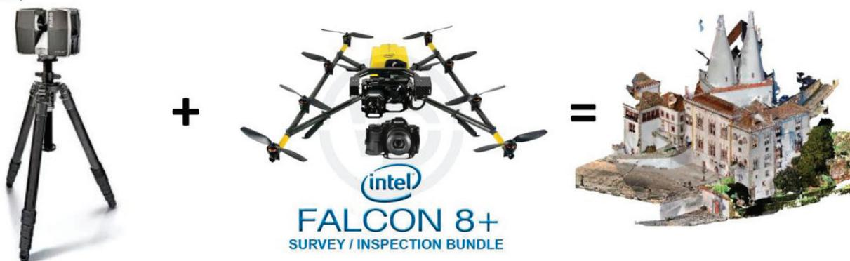
**Figura 3** Equipamento usado para o levantamento geométrico do PNS: laser Faro Focus S 70 (esquerda); drone Falcon 8+ (meio); nuvem de pontos gerada (direita)
