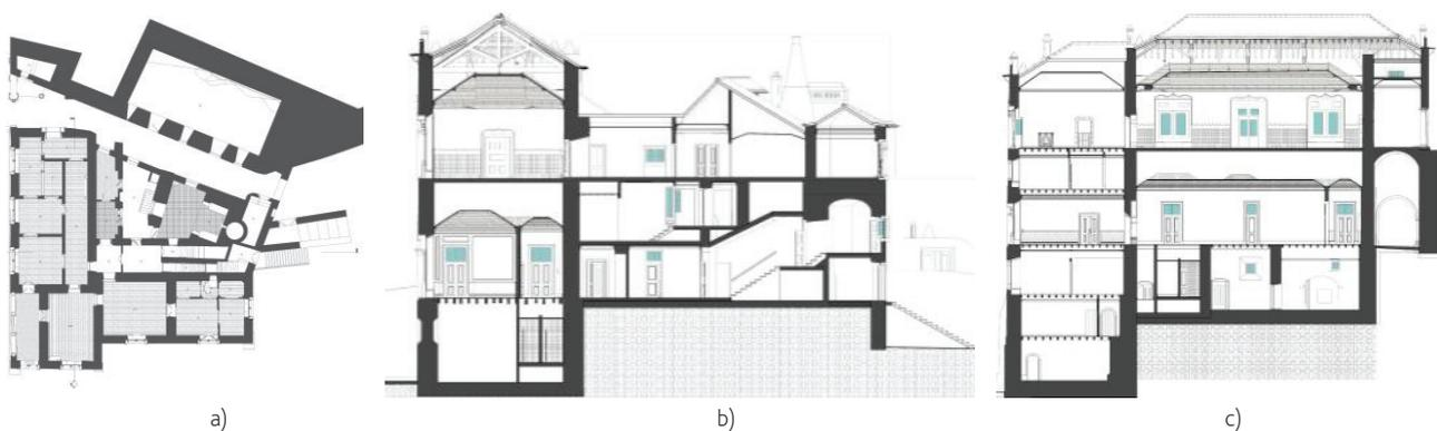
Figura 7 Exemplos de informação 2D extraídos diretamente do modelo H-BIM 3D da Ala Manuelina: a) Planta do 2.º piso (escritórios); b) Corte 01-NS; e c) Corte 02-EO
