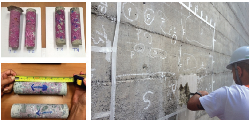
Figura 1 À esquerda: testemunhos extraídos das fachadas do edifício Artigas com a indicação das frentes de carbonatação. À direita: delimitação de área para a realização de ensaios eletroquímicos e remoção da argamassa de reparo para o acesso às armaduras (Fotos: Acervo ConservaFAU, 2017, disponibilizadas pelas autoras)
