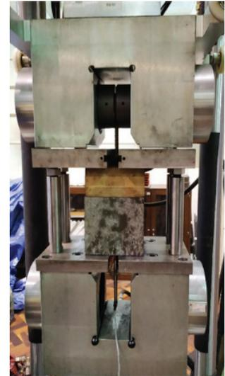
Figura 2 Provetes dos ensaios de arrancamento segundo a EN 10080:2005 [22]
