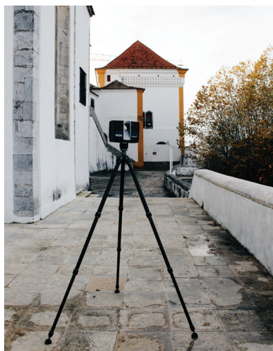
Figura 4 Equipamento de levantamento geométrico (varrimento laser) com o Edifício dos Brasões ao fundo
