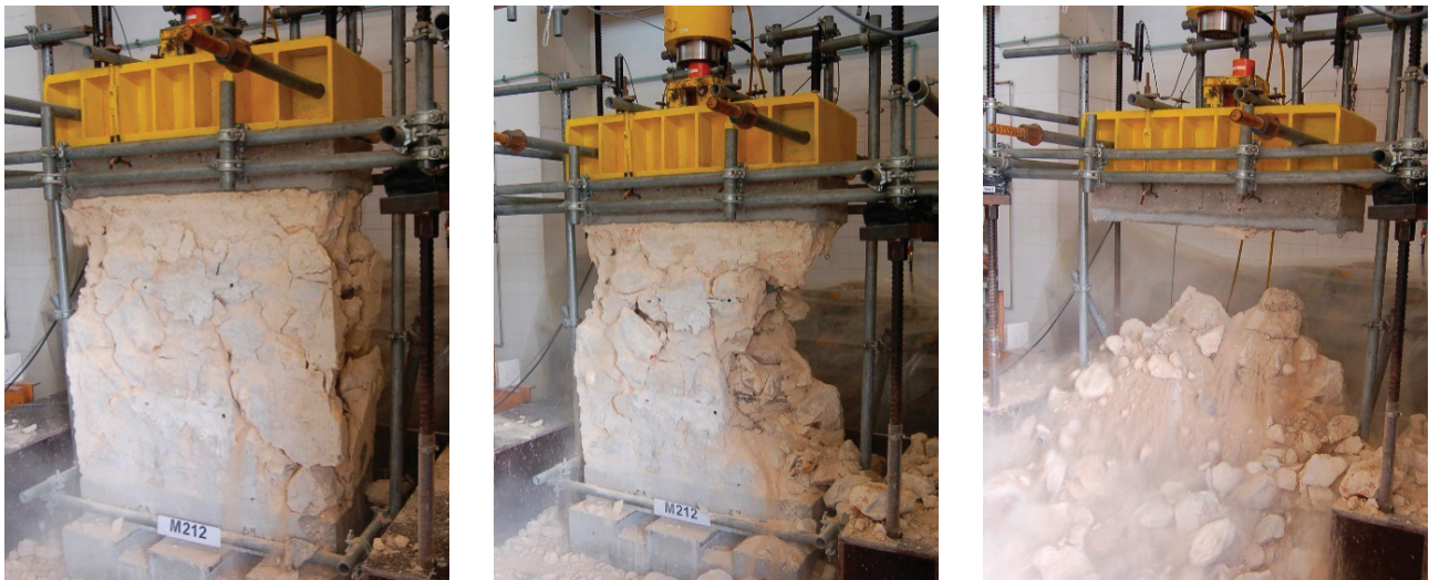
Figura 6 Evolução do ensaio de compressão axial do murete M212 até à rotura
