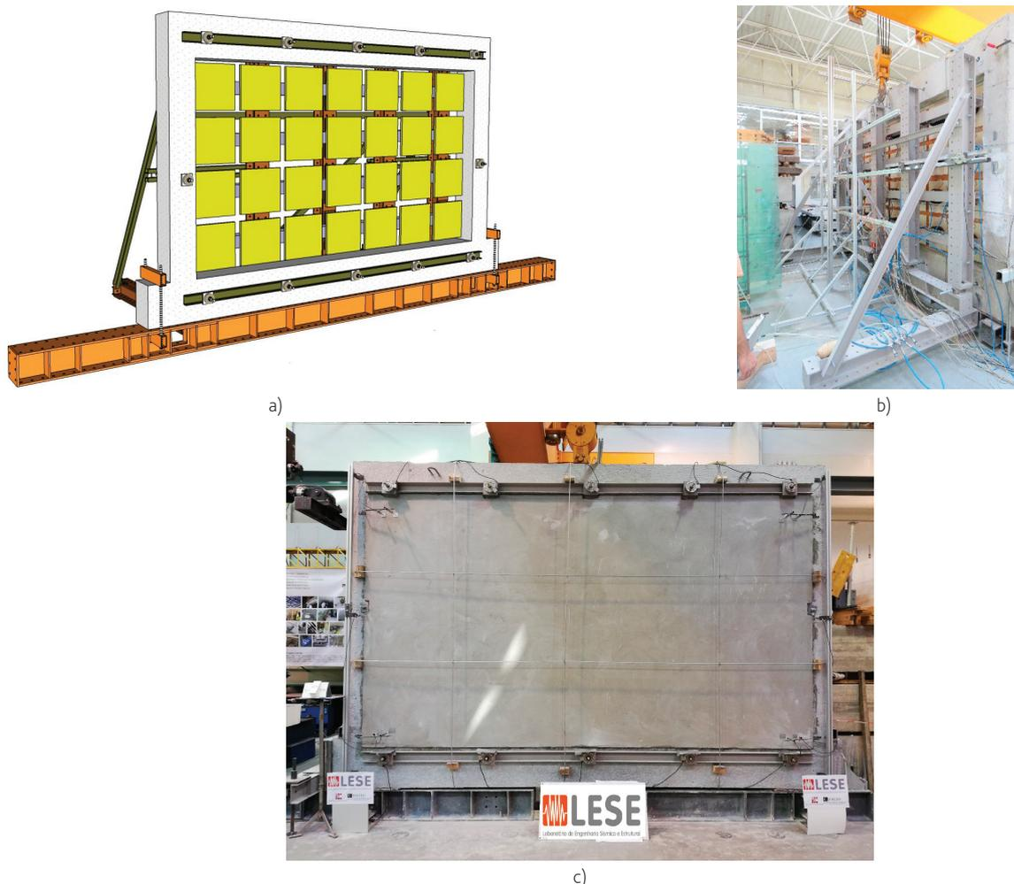
Figura 4 Setup experimental: a) esquema geral; b) vista lateral; e c) vista frontal
