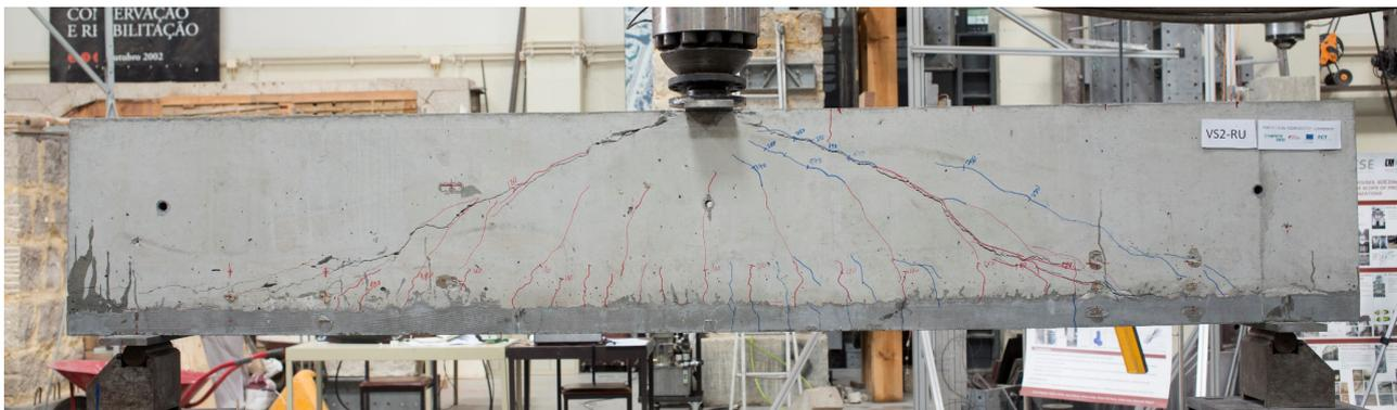
Figura 6 Padrão de fendilhação da viga VS2-RU após o ensaio
