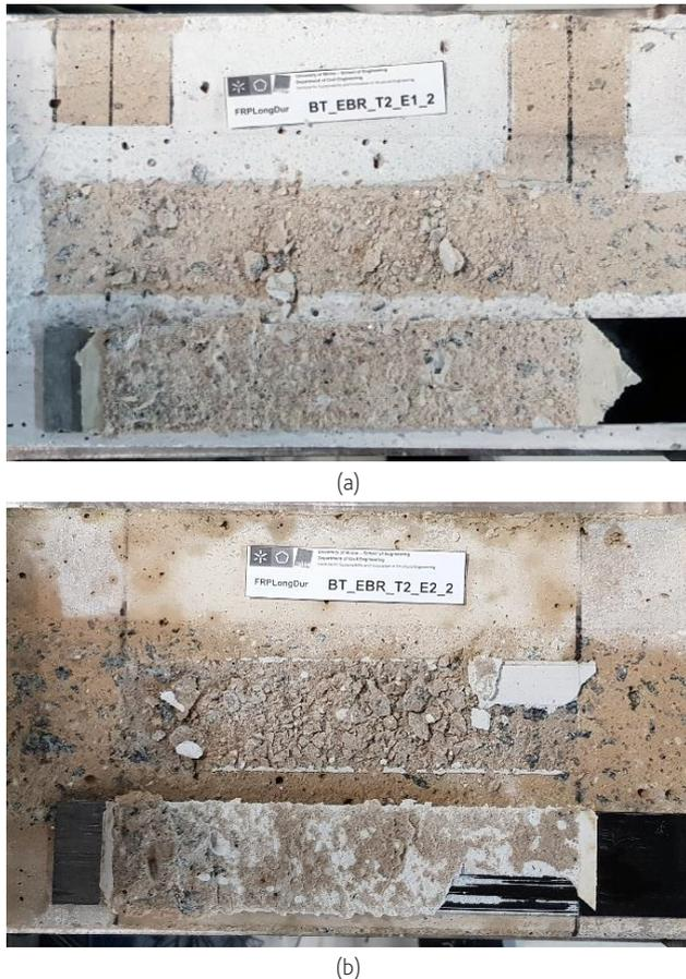
**Figura 5** Modos de rotura típicos observados nos ensaios de aderência EBR: (a) rotura coesiva do betão - C e (b) rotura coesiva do betão e destacamento na interface laminado-adesivo - C + F/A
