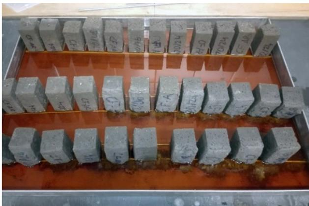
Figura 15 Ensaio de absorção de água por capilaridade
