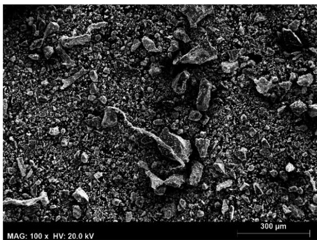
Figura 1 MEV de CFRSU moída
