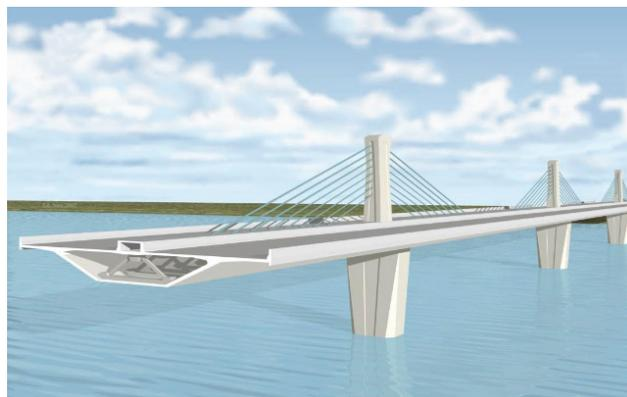
**Figura 28** Exemplo de uma ponte com pré-esforço extradorsal com secção transversal em caixão [12]
