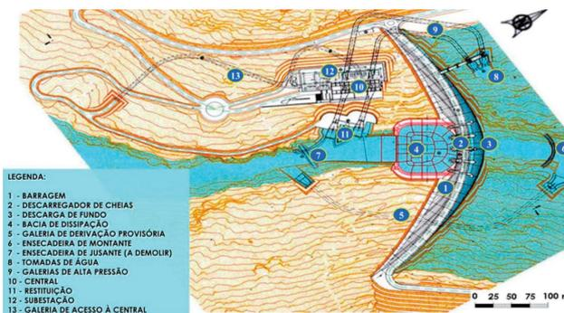
Figura 1 Planta geral das obras do escalão de montante do AHBS
