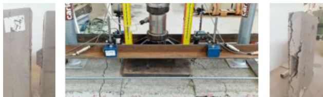
Figura 11 Rotura por flexão num dos provetes da série OOP-P2
