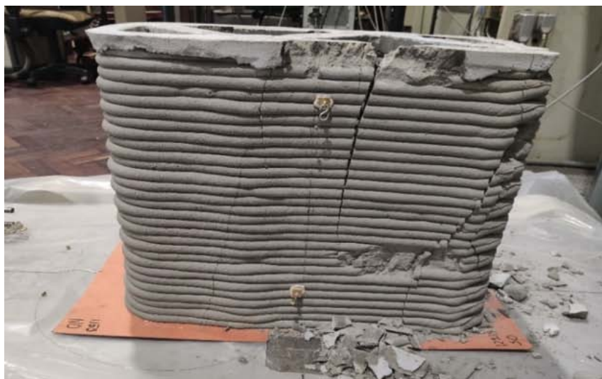
Figura 15 Mecanismo de rotura obtido após ensaio do modelo 2
