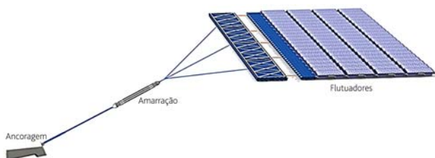
Figura 2 Subsistemas de uma plataforma FPV
