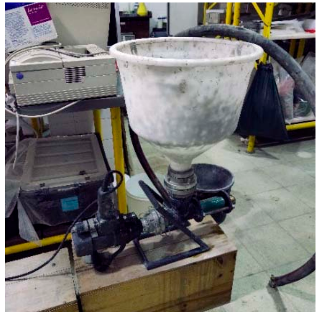
Figura 5 Bomba, rotor, funil e mangueira de impressora 3D
