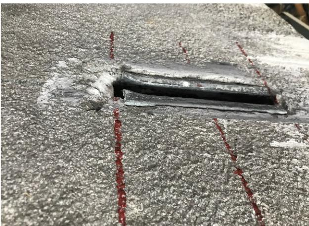
i) Deformação da calha CPC\_O\_14
