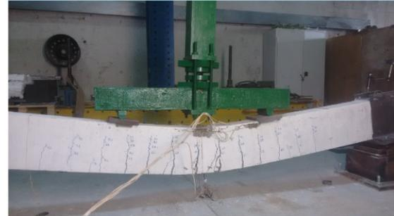
Figura 9 Comparação numérico vs experimental das configurações deformadas das vigas para as máximas flechas atingidas
