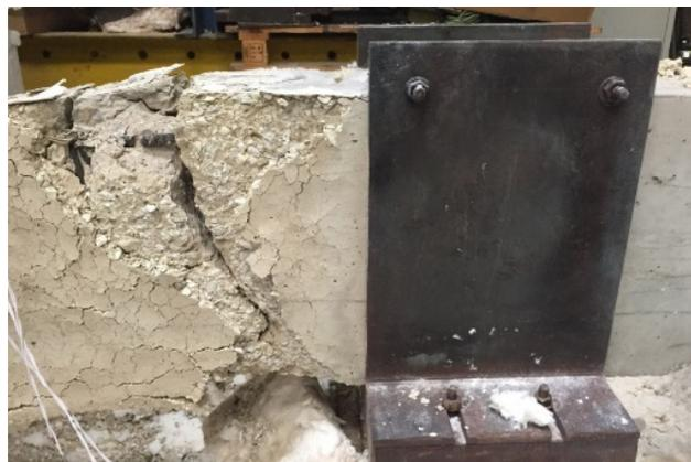
**Figura 17** Rutura de uma das armaduras superiores próximas ao apoio duplo (região dos momentos negativos) da viga ka1\_kr2\_2
