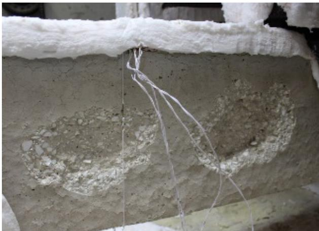
**Figura 14** Destacamento de pedaços de concreto na viga ka1\_kr0\_2
