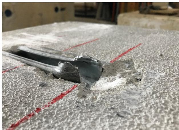
d) Falha da calha CPC\_O\_06
