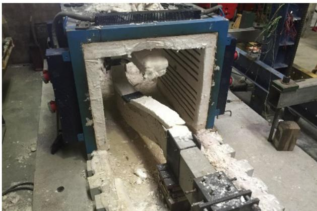
**Figura 16** Instabilidade lateral com torção em ka1\_kr2\_1
