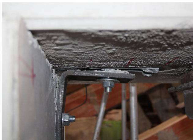
c) Parafuso expulso da calha CPC\_O\_06
