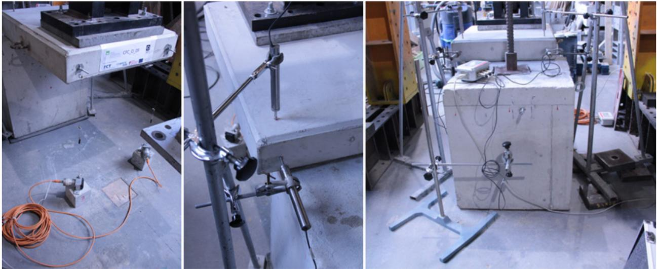
Figura 9 Esquema de instrumentação adotado para os ensaios fora do plano
