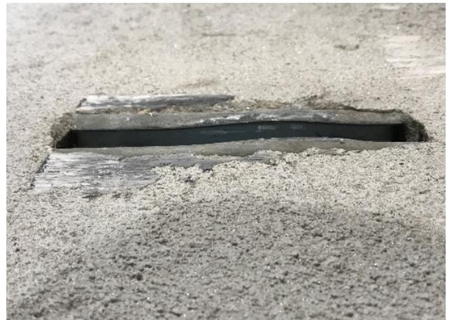
h) Deformação na calha, sem falha CPC\_O\_10
