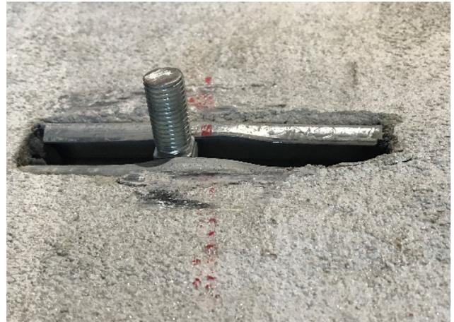
f) Deformação na calha, sem falha CPC\_O\_09
