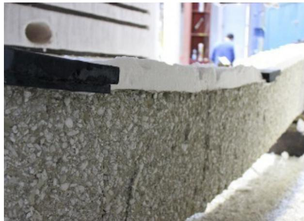
**Figura 15** Deformada de ka2\_kr0\_2, com esfoliação do concreto da superfície
