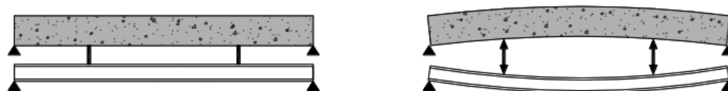
Figura 10 Comportamento do sistema (a) sem pós-esforço; (b) com pós-esforço.
