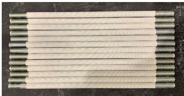
Figura 4 Parafusos revestidos de gesso, para minimizar o atrito com a madeira
