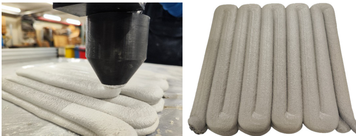
Figura 8 Validação da capacidade de impressão das formulas cimenticias desenvolvidas
