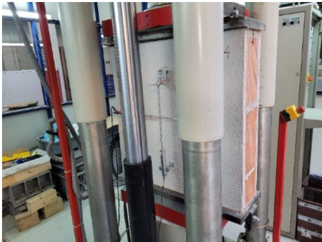
Figura 2 Exemplo da configuração do ensaio de compressão e tensão-extensão obtida para muretes de alvenaria com reboco reforçado M2 (curva tracejada obtida através de técnicas de regressão numérica não linear com base nos resultados experimentais)
