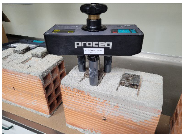
Figura 7 Exemplo dos ensaios à tração e ao corte entre tijolo/junta
